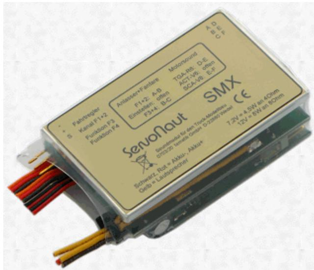
Le module de sonorisation **SMX** pour camions et modèles à fonctions multiples utilise la synthèse numérique pour la génération des sons spécifiques au modèle choisi. Il s'agit d'enregistrements originaux de bruit de moteur de camions, d'avertisseurs de camion et d'autres sons spécifiques stockés numériquement et reproduits dans une excellente qualité par le module **SMX**.
